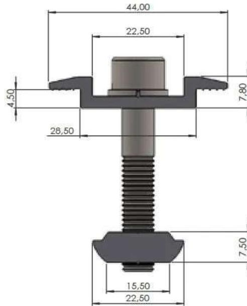
Figura 3- Dimensões mínimas em milímetros - Fixador Grampo Intermediário Mid Clamp
