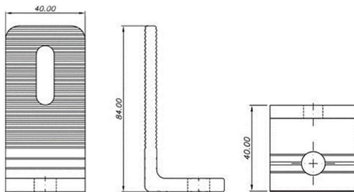
Figura 6 - Dimensões mínimas em milímetros Suporte Pé em L
