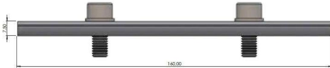
Figura 1- Dimensões mínimas em milímetros - Emenda para Perfil H2
