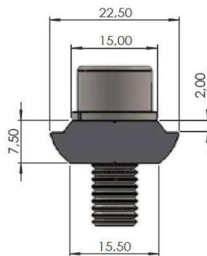
Figura 2- Dimensões mínimas em milímetros para Parafuso de conexão de emenda de Perfil H2 e Fixador Grampo End Clamp
