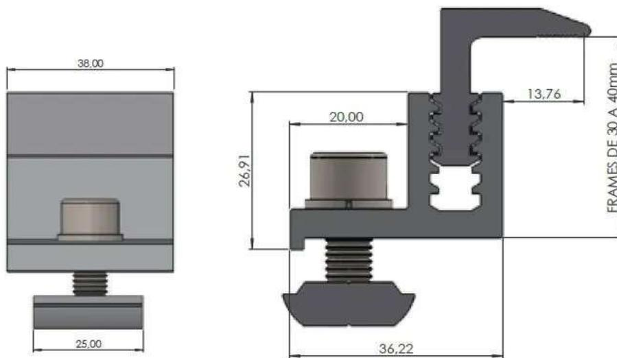
Figura 4- Dimensões mínimas em milímetros - Fixador Grampo End Clamp
