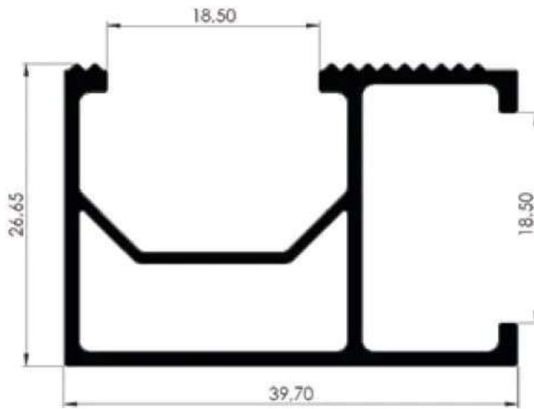
Figura 5 - Dimensões mínimas em milímetros - Perfil H2
